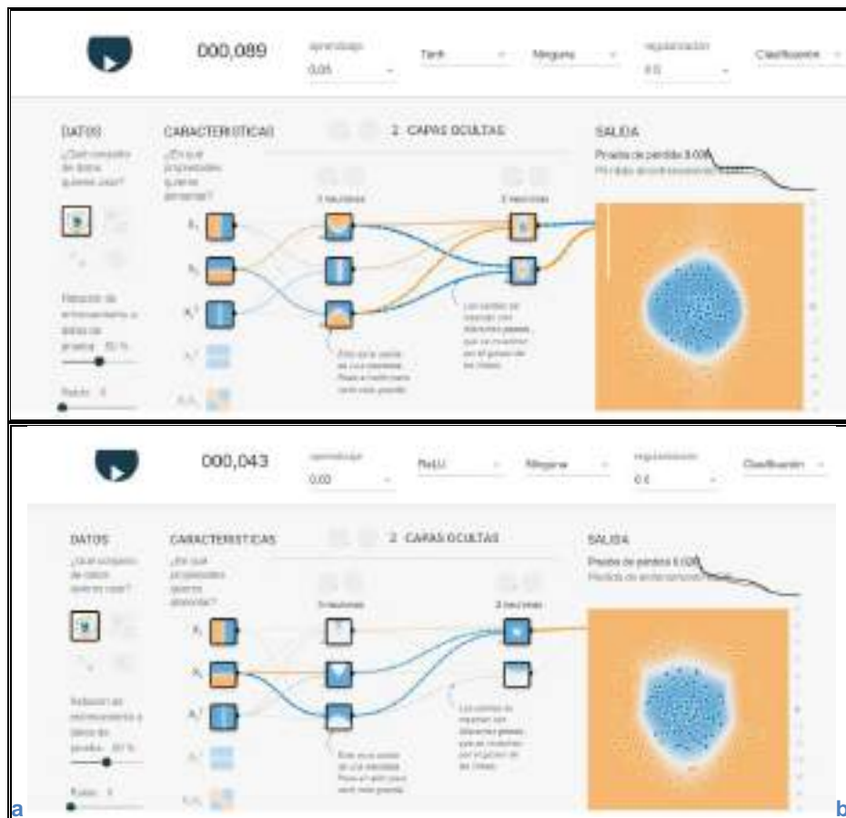
Figura 15: Simulación con 2 capas ocultas problema con activación a) RELU y activación b) Tanh usando simulador de redes neuronales de playgroundtensorflow.
