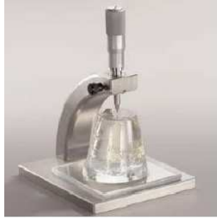
Figura II.9: Ridgelmómetro (equipo para medir la graduación de la pectina)
