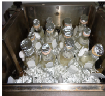
Figura III. 2: Frascos Erlenmeyer conteniendo la mezcla de reacción (material vegetal +EE+buffer), incubados en shaker rotatorio a 150 rpm.
