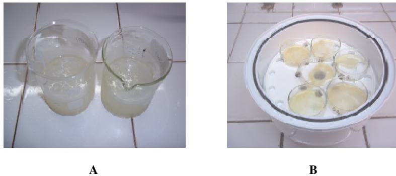
Figura III. 4: Gel de material polimérico, luego de la precipitación con etanol (A). Material insoluble en etanol secado a 40 °C (B)
