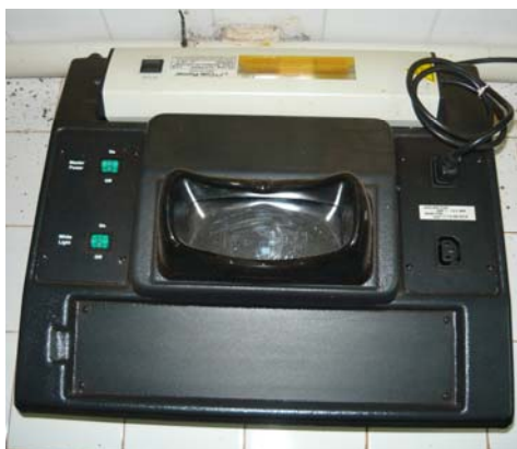
Figura 3.3: Lámpara UV 254-365 nm con cámara de visualización. Laboratorio del Dpto. de Farmacia - FCEQyN.
