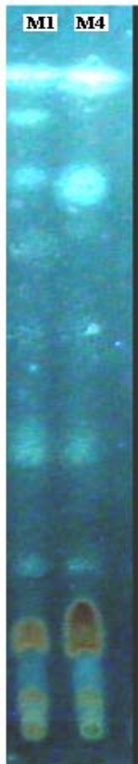
Figura 4.4: TLC de extractos de terpenos en cangorosa. FM: Cloroformo–Benceno. Revelador: anisaldehído–sulfúrico bajo luz UV a 365 nm. M1: Muestra 1, M4: Muestra control.
