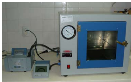
Figura 3.2: Estufa de secado al vacío. Laboratorio del Dpto. de Farmacia - FCEQyN.
