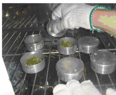
Figura 4.2: Ensayo de pérdida por secado de hojas de M. ilicifolia (secado de muestras). Laboratorio Dpto. de Farmacia - FCEQyN.
