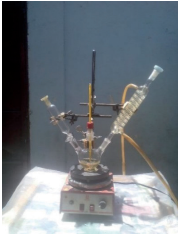
Figura 1: Montaje experimental utilizado para las reacciones foto-Fenton.
