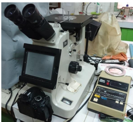
Figura 3.4. Fotografía del microscopio utilizado para la caracterización superficial.
