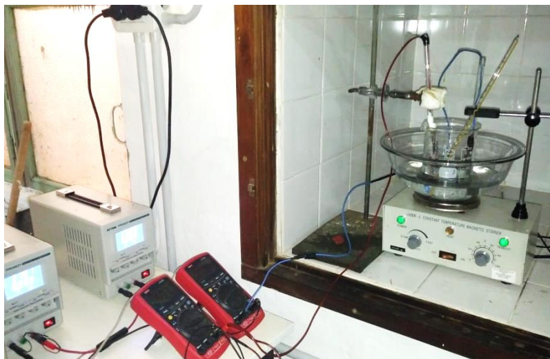
Figura 3.3. Fotografía del sistema de anodización utilizado.
