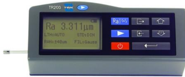
Figura 3.7. Fotografía del rugosímetro TR200 utilizado en las mediciones de rugosidad.
