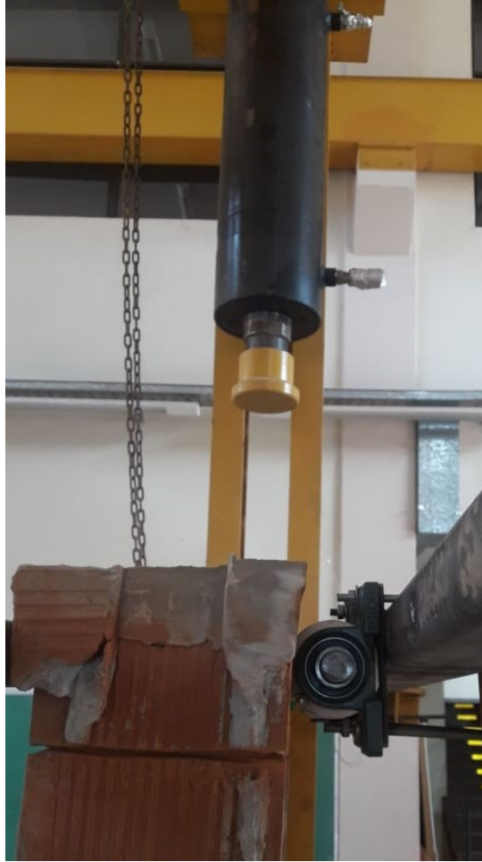
Figura 7.3. Condiciones de borde impuestas en la parte superior de los paneles.
