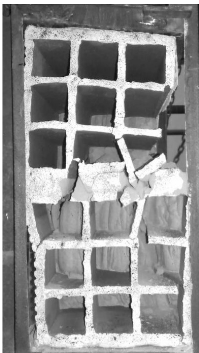
Figura 6.5. Ensayo a compresión: fallas en celda 4.-
