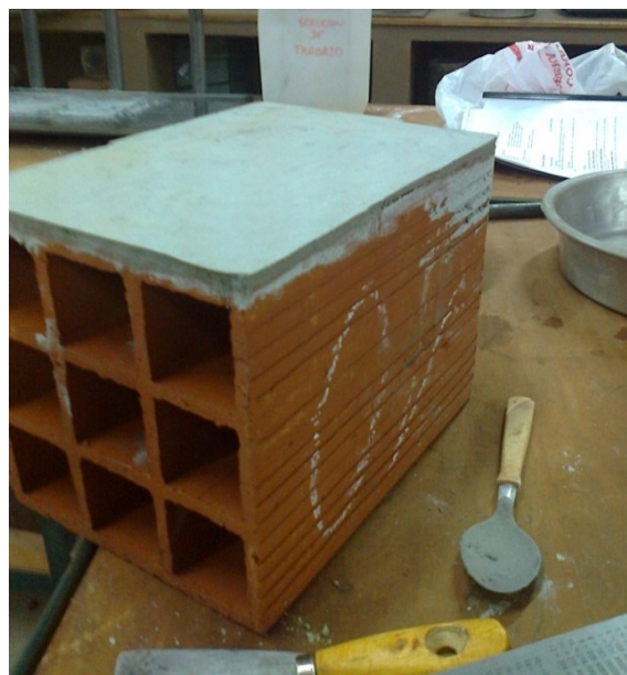
Figura 5.3. Ladrillo LCH 18 18 25 encabezamiento de caras horizontales.-
