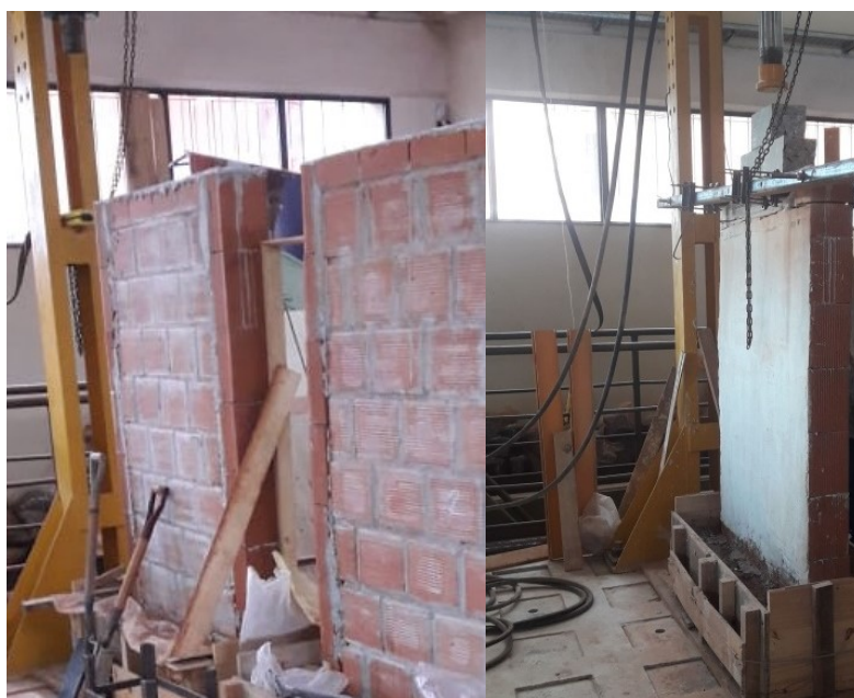
Figura 7.7. Preparativos de Ensayo tipo CCBF: carga centrada sobre base flexible.
