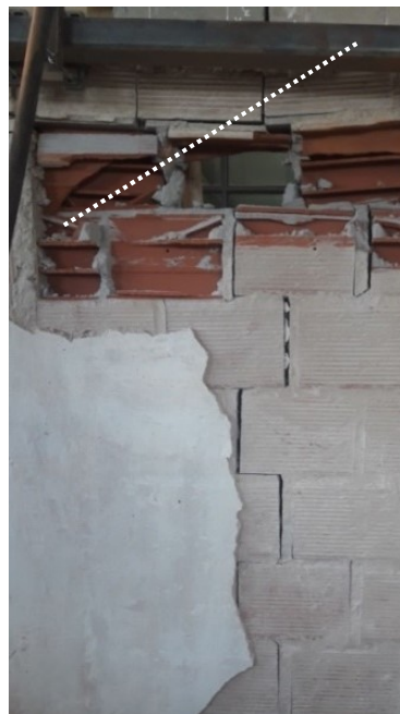
Figura 7.31. Esquema general de fallas ocurridas en el Panel 4.
