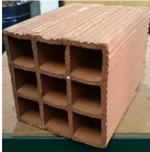
Figura 5.2. Ladrillo LCH 18 18 25 para ensayar a compresión.-
