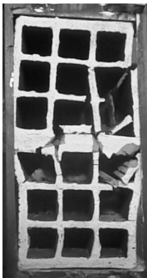
Figura 6.7. Ensayo a compresión: fallas en celda 14.-
