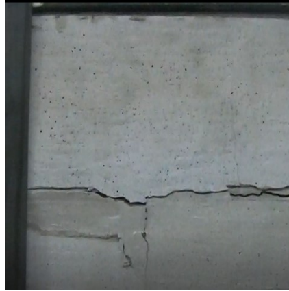
Figura 6.9. Ensayo a compresión: fallas en celda 11 lateral.-
