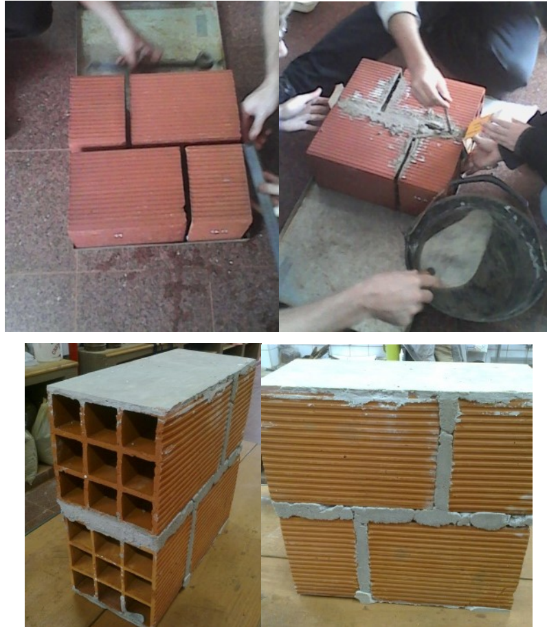
Figura 6.1. Elaboración de una celda de mampostería.-
