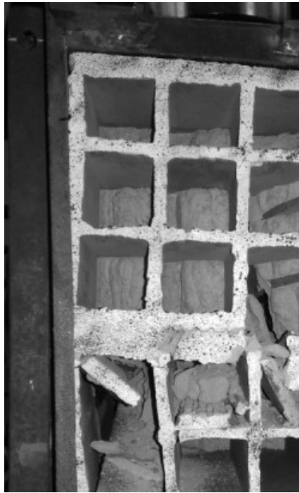
Figura 6.4. Ensayo a compresión: fallas en celda 1.-
