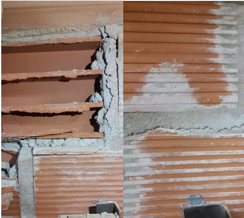
Figura 7.21. Fallas locales en Ensayo tipo B: Carga centrada sobre base flexible.
