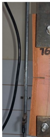
Figura 4.4. Ensayo a tracción de una probeta de cerámica tallada de un ladrillo LCH.
