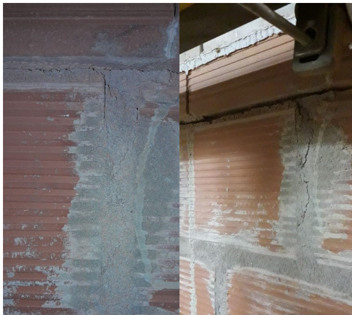
Figura 7.22. Fallas locales en Ensayo tipo B: Carga centrada sobre base flexible.
