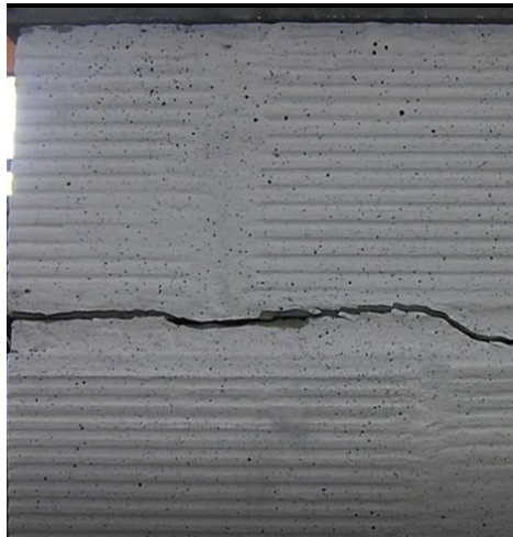
Figura 6.11. Ensayo a compresión: fallas en celda 2 lateral.-
