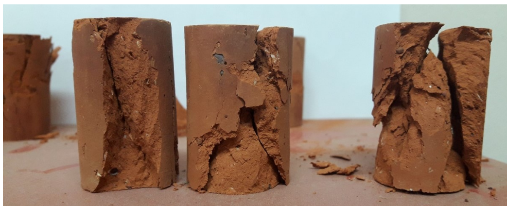
Figura 4.9. Trayectoria de las fisuras en probetas de cerámica.
