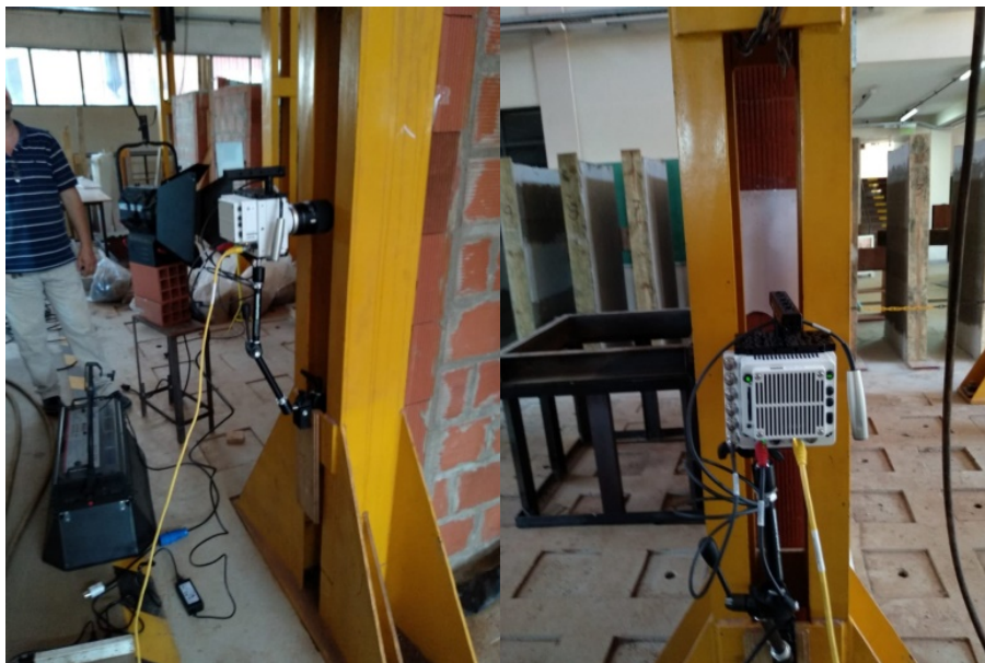
Figura 7.6. Preparativos de Ensayo tipo A: carga descentrada sobre base rígida.
