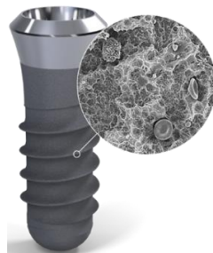
Figura 41. Imágenes SEM del tratamiento SLA. [260]
