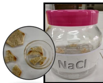
Figura 24: metodología utilizada para la determinación del contenido de humedad de equilibrio
