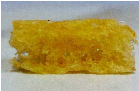
Figura 41: corte transversal de muestra D (100% PDM) donde se observa la porosidad
