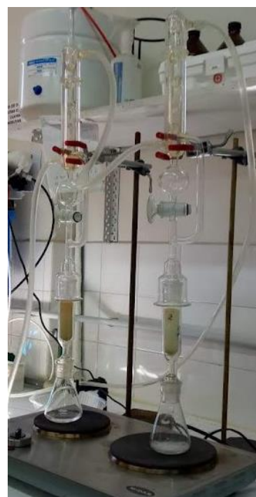
Figura 18: fotografía del proceso de extracción de lípidos
