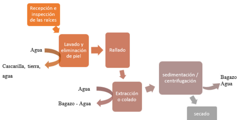
Figura 1: Diagrama del proceso de extracción de fécula de mandioca
