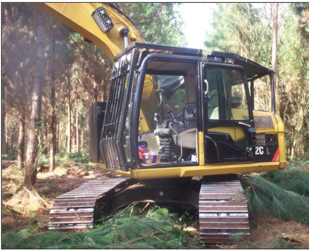
Figura 1. Excavadora con oruga. Figure 1. Crawler base machine.
