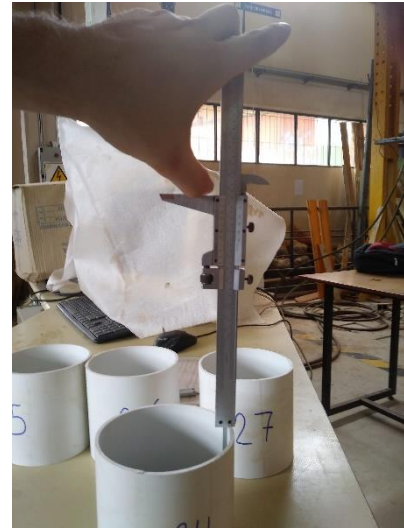
Fig. 1 (b). Medición del Permeámetro con calibre de precisión.
