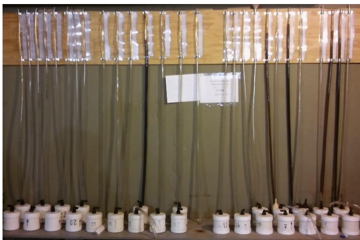
Fig. 11. Permeámetros colocados en la Banca de Ensayos.
