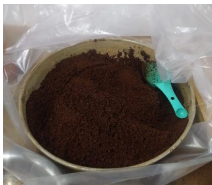
Fig. 3. Suelo preparado a la humedad requerida.
