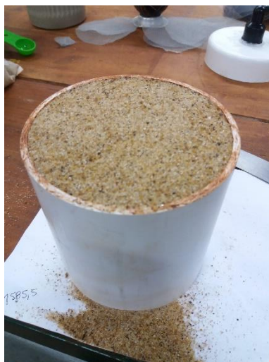
Fig. 7 (b). Capa de Arena Mediana del Filtro.
