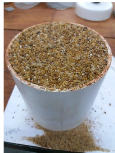
Fig. 7 (b). Capa de Arena Gruesa del Filtro.
