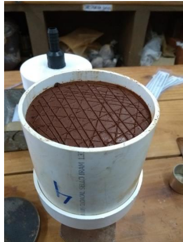
Fig. 6. Rugosidad generada en el Suelo compactado.
