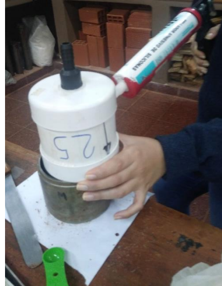
Fig. 8 (b). Sellado de la Probeta con silicona.
