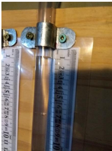
Fig. 10. Montaje de mangueras y reglas.
