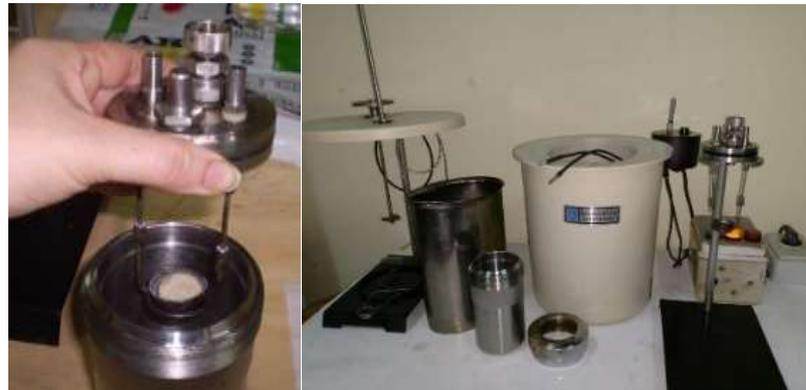
Figura 4. Bomba calorimétrica con patilla de madera y calorímetro Parr® modelo 1341
