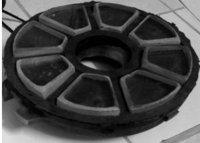
Figura 2. Imagen de los cojinetes de vidrio diseñados, fabricados y montados (Fuente propia, 2017)
